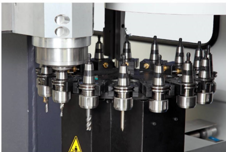
Werkzeugwechsler 16-fach für SK und HSK Tool changer for 16 tools for SK und HSK
