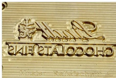
Messing-Prägwerkzeug mit Spiegelbearbeitung Brass embossing die for processing of mirror surface
