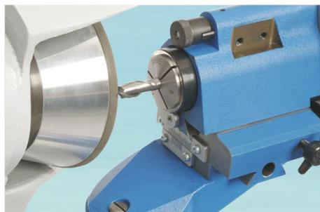
Nachsleifen eines Fräasers mit 2 Schneiden
