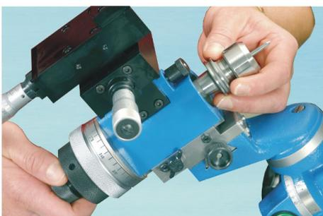
Kurze Wechselzeit mit Kegel-Direktspannsystem
