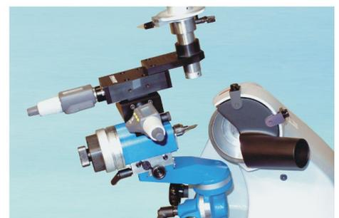
Langer Schwenkarm und langer Messschlitten für MSK
